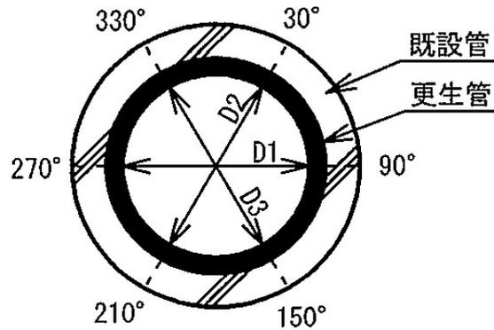
図1 更正管仕上がり内径の測定位置
